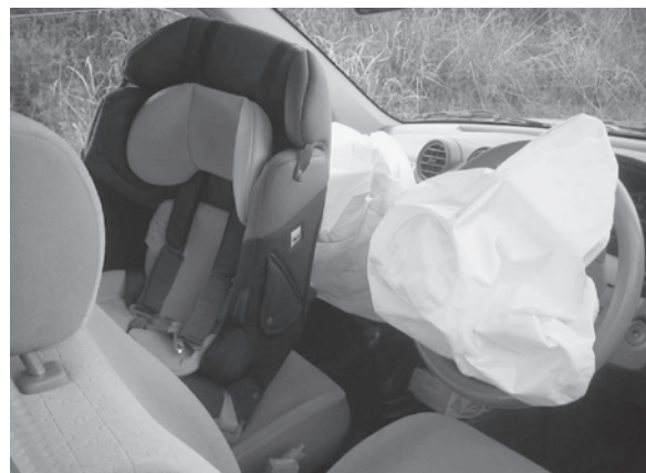
図2 助手席に設置されたチャイルドシート。運転席と助手席のエアバッグが展開している。
