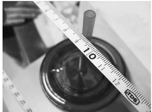
写真2 ストローの外径は7mm, 内径は5mm. ストローは曲がらず, ほぼ上下方向にしか動かず, PET樹脂でできていて硬い.
