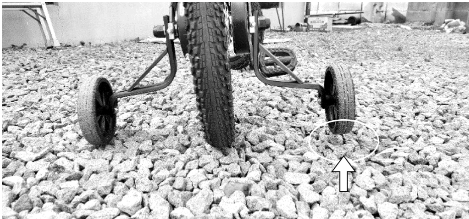
【図 1】 補助輪を装着した自転車。補助輪はまっすぐ立った状態で両側の補助輪が地面から 1-2cm 程 (傾くと 4 cm 程) 浮く状態であった (矢印部分)。
