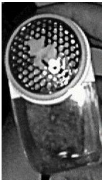
図 1 電動毛玉取り器の欠損した網刃部分
