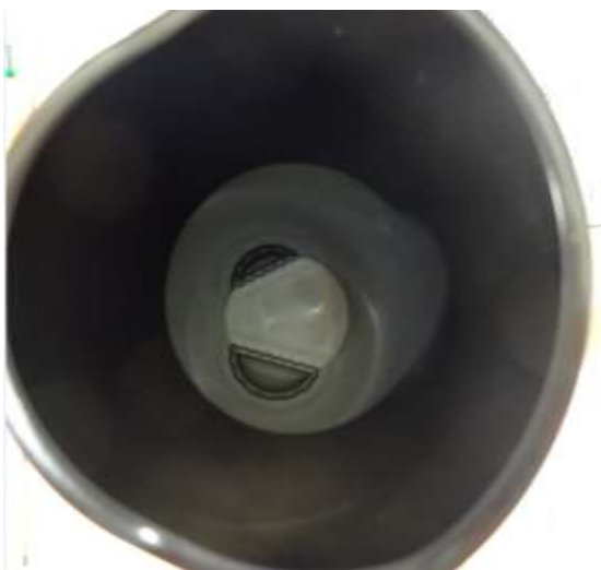
図 3. : 投入口を上方から見た様子。奥にカッター部分が見えている。(投稿者撮影)
