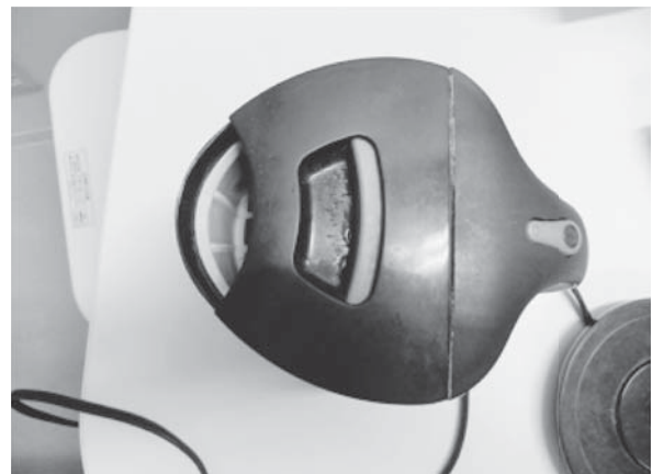
写真4 電気ケトルを上方からみた図。注ぎ口が開放されており、簡単に熱湯が流出する構造になっている。
