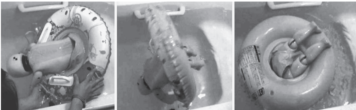
図4 ダミー人形による浴槽用浮き輪の転覆実験
